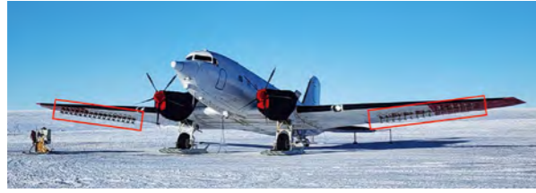
[그림 2] 극지연구소에서 개발한 IPR 안테나(양쪽 날개 아래 붉은색 박스)를 장착한 Basler 항공기
